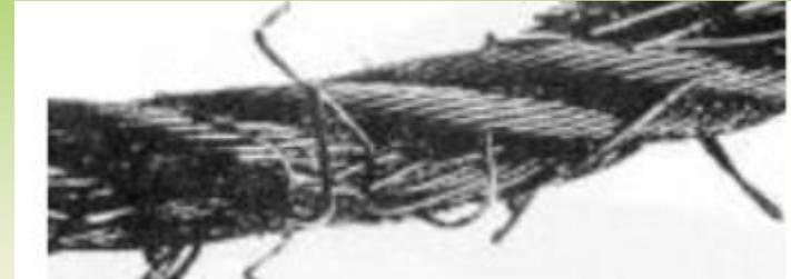
*Esempio 2:* effetti cumulativi di più fattori di deterioramento. Usura dei fili esterni, deformazione a canestro e molti fili rotti.
