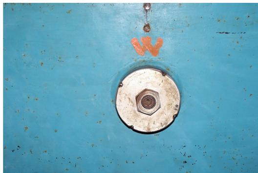
2. Smontare i 3 blocchi di ancoraggio dello specchio, iniziando da quello a ovest.
