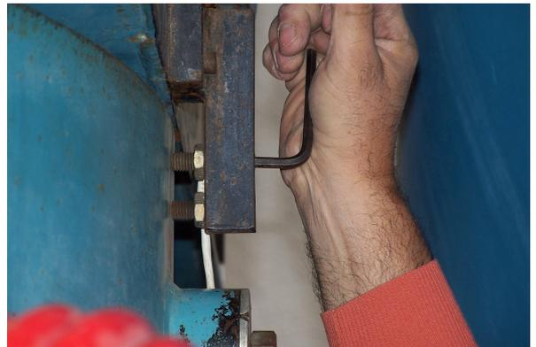
4. Si procede ora con lo scollegare la culla dal telescopio svitando regolarmente e contemporaneamente le viti delle 3 candele. Durante questa fase procedere in modo che tutta la struttura che contiene lo specchio primario scenda parallelamente al pavimento.
