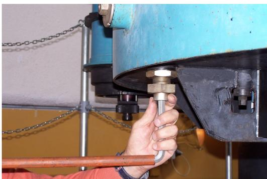
Sostituire alle tre viti appena tolte le tre viti a candela e avvitarle manualmente fino a battuta (saranno quelle che reggeranno la culla).
