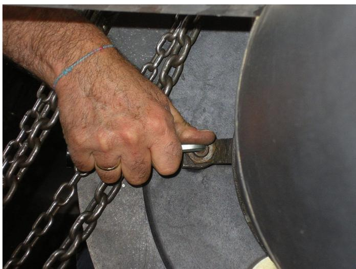
21. Si deve ora togliere paranco e il suo legno di fissaggio al traliccio del telescopio e procedere con il fissaggio del buffer secondario e primario. Ricordarsi di far coincidere le tacche di riferimento presenti sulla montatura telescopio con quelle sul buffer.
