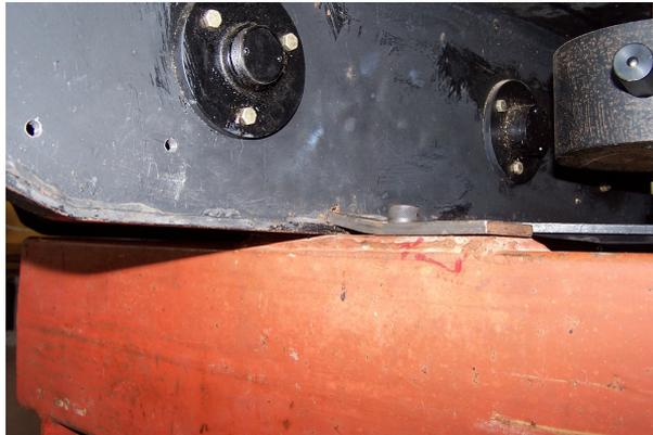
Abbassare il pavimento di circa 5 - 10 cm e continuare ad allentare i dadi delle candele fino a che tutto appoggi bene sul pavimento ( a questo punto i dadi sono liberi).
