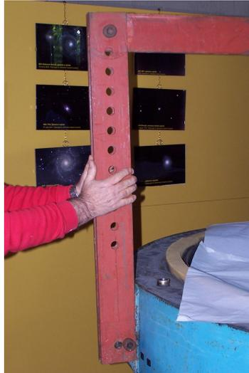
4. Sollevare lentamente la culla. Nell'eseguire questa manovra occorre fare molta attenzione che i 3 pattini laterali non intralcino l'inserimento dello specchio all'interno della culla. Controllare (utilizzando le mani) che, al termine dell'operazione, i pattini siano posizionati orizzontalmente.
