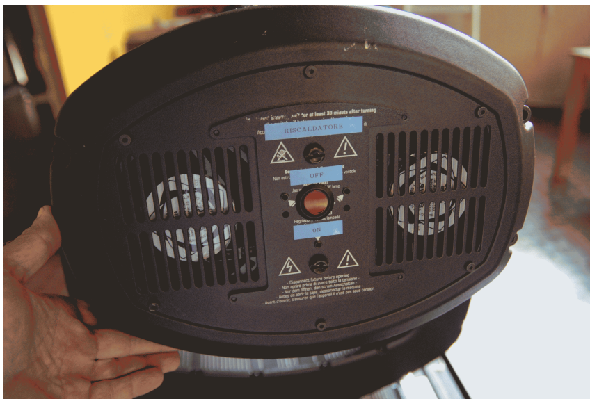
Figure 11: Interruttore che abilita il circuito di riscaldamento
