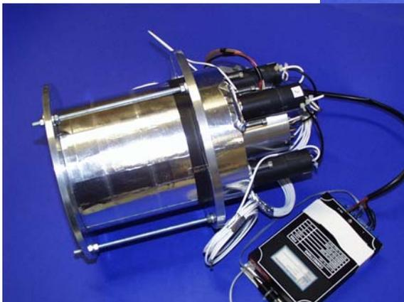
Assemblaggio del plastico di Anticoincidenza, dei fotomoltiplicatori e del modulo di HV.
