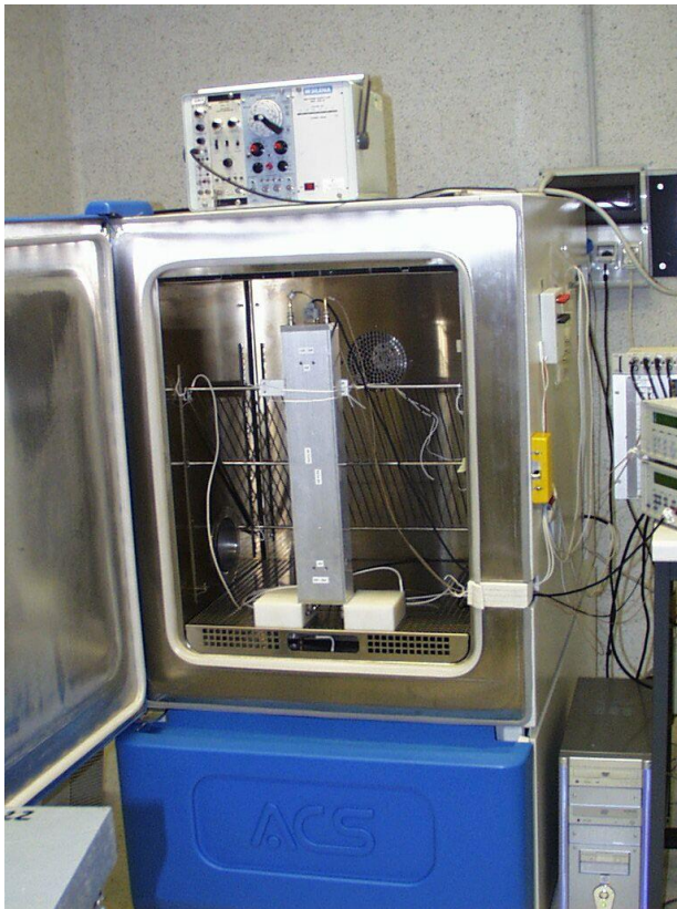
Fig 2a Piazzamento barre in camera climatica
