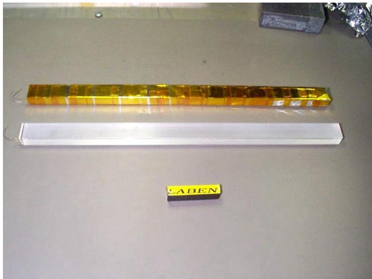
**Figura 1-1** Sotto le barre con PD incollati. Sopra le barre complete di rivestimento, nella configurazione tipica per le misure pre-housing.
