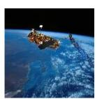
L'esperimento **MIPAS** opera a bordo del satellite Envisat , lanciato da ESA nel marzo 2002. E' il primo strumento che è ha osservato l'atmosfera terrestre in modo globale con la tecnica di osservazione al lembo, fornendo la misura della composizione atmosferica risolta geograficamente, nel tempo ed in altezza. L'aggiunta della dimensione quota ha richiesto la soluzione di un complesso problema d'inversione e la gestione di una ancor più grande quantità di dati.
