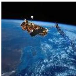
L'esperimento **MIPAS** opera a bordo del satellite Envisat, lanciato da ESA nel marzo 2002. È il primo strumento che ha osservato l'atmosfera terrestre in modo globale con la tecnica di osservazione al lembo, fornendo la misura della composizione atmosferica risolta geograficamente, nel tempo ed in altezza. L'aggiunta della dimensione quota ha richiesto la soluzione di un complesso problema d'inversione e la gestione di una ancor più grande quantità di dati.
