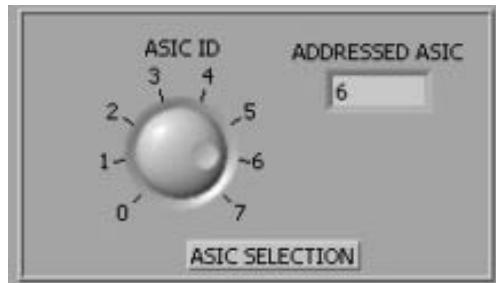
**Figura 17 Comando di selezione dell'ASIC.**
