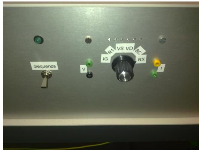
**Figura 14 Switch di comando sequenza di accensione rivelatori**
