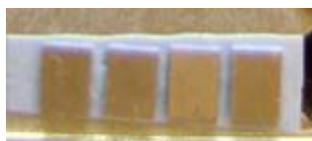
Figura 6 Piazzole di saldatura SnPb / Bondwire
