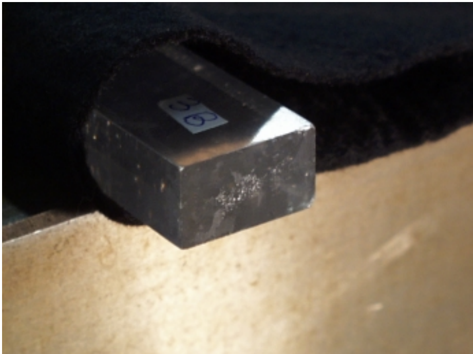
Figura 4b. Barra 3 durante la lavorazione alla fresa: sono visibili le disuniformità del cristallo.
