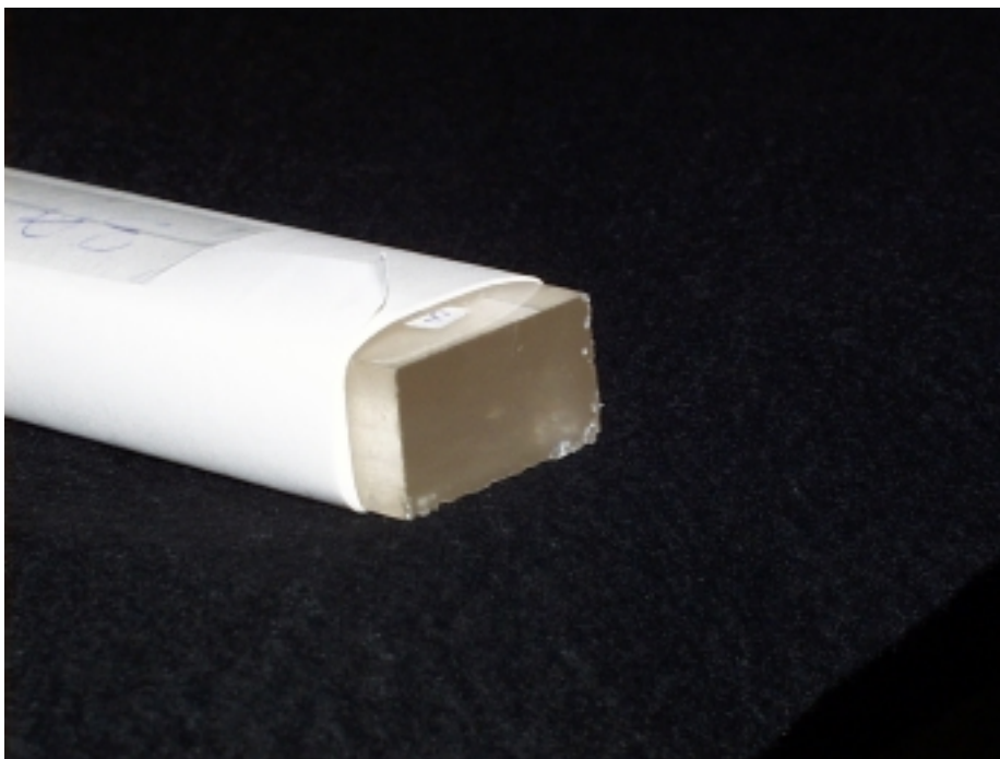
Figura 4c. Barra 3 dopo la lavorazione alla fresa.
