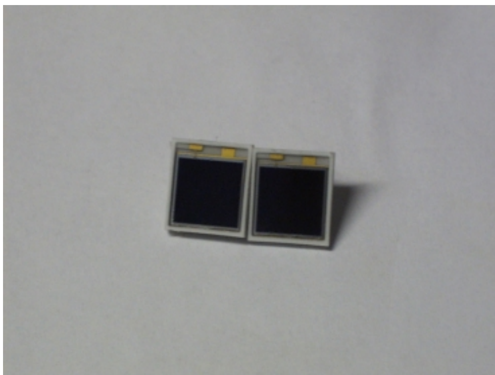
Figura 3. Fotodiodi modello Hamamatsu S3590-08 accoppiati alle barre del prototipo del MCAL di AGILE.
