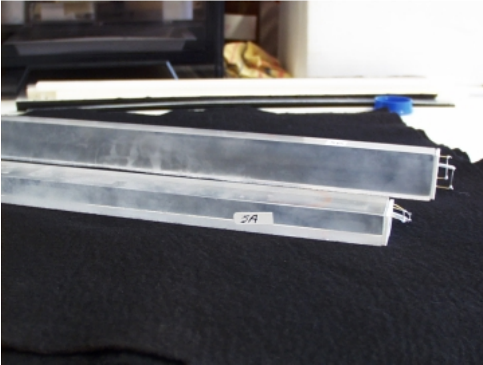
Figura 6. Barre Crismatec prima della lavorazione: si noti la superficie più lucida.
