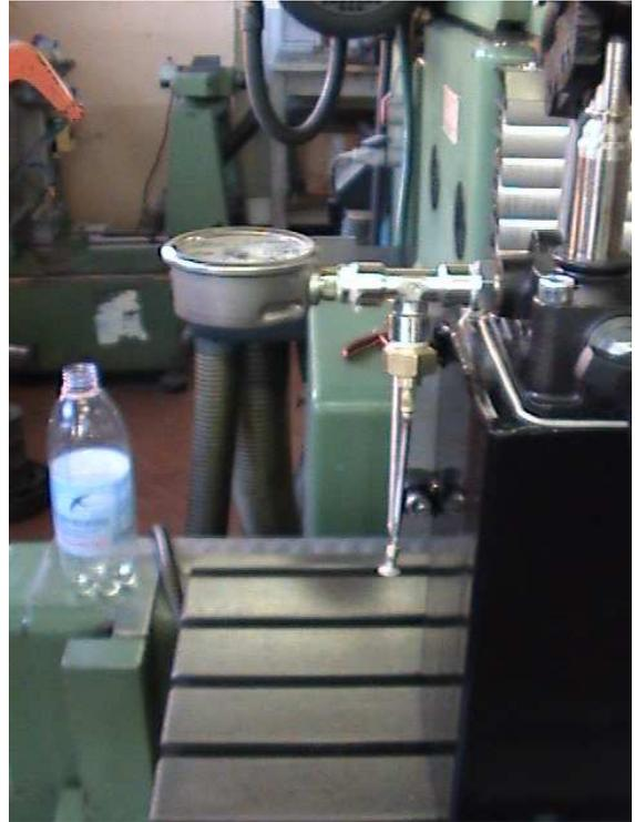
La pompa è stata fissata sul banco della fresatrice in modo da permettere un appoggio sufficientemente solido per la prova.
