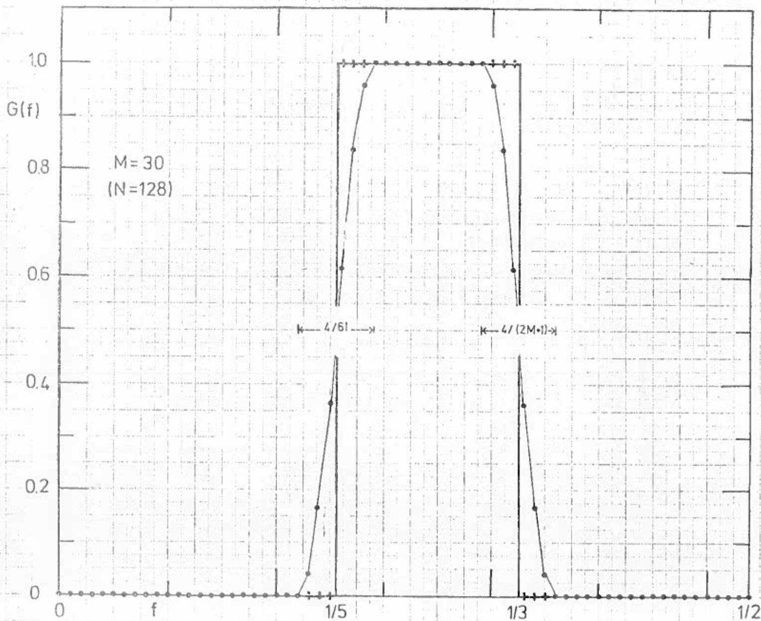
Fig. 4 - Un esempio di calcolo di un filtro passa banda  $(1/5, 1/3)$  con la condizione di  $(2M+1)=61$  coefficienti e bande di raccordo a zero non superiore a  $4/(2M+1)$ . Come si vede fuori dalle bande di raccordo, lo scostamento della risposta dall'ampiezza prevista è impercettibile:
