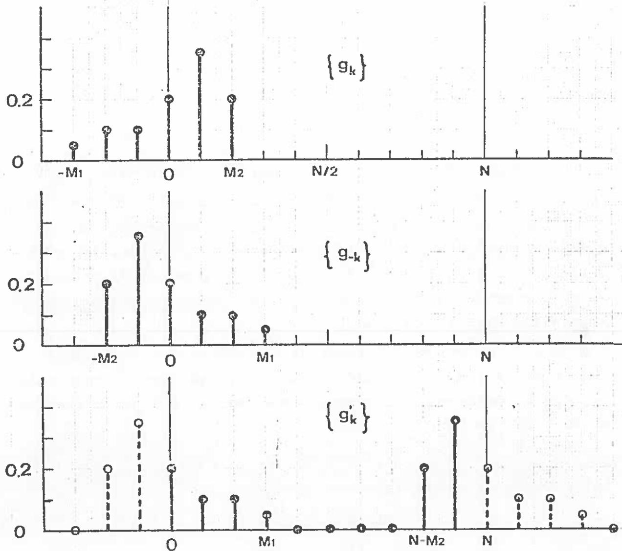
Fig. 1 - Esempio di serie di coefficienti  $\{g_k\}$  per filtraggio con media mobile pesata;  $\{g_{-k}\}$  è la risposta in impulso del filtro e  $\{g'_k\}$  è l'insieme dei coefficienti richiesti per il filtraggio via TVF.
