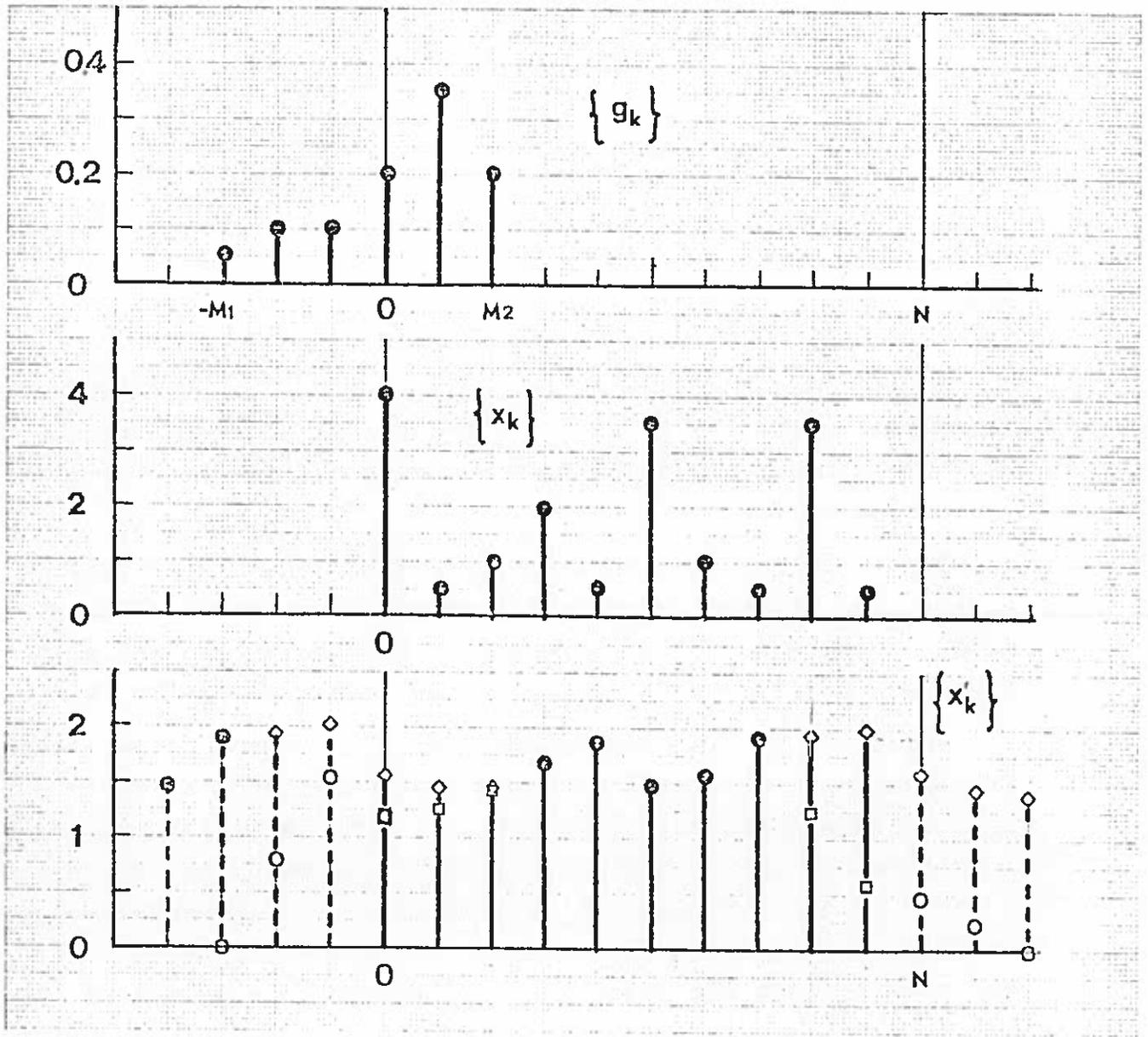
Fig. 2 - Un esempio di filtraggio con media mobile pesata e mediante TVF:  $\{g_k\}$  è la serie dei coefficienti;  $\{x_k\}$  è la serie dei dati da filtrare;  $\{x'_k\}$  rappresenta la serie filtrata.
