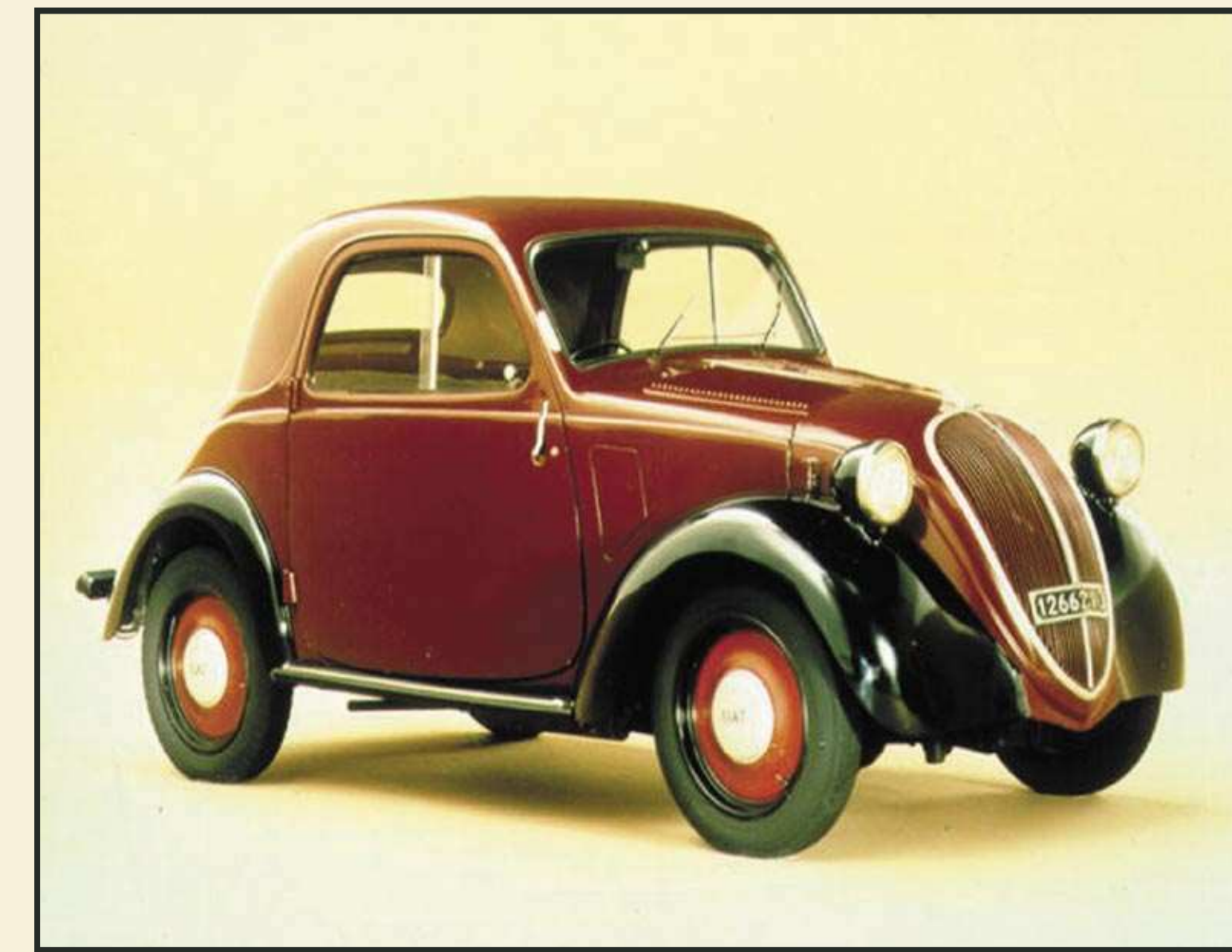
Il 1936 è l'anno di nascita della Fiat 500, ribattezzata dal pubblico “Topolino”. La vettura ha un motore da 1300, una velocità massima di 85 km/h e consuma 17 km con un litro; il costo è di 9750 lire (ca. 8500 euro).
