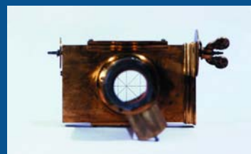
Il reticolo di fili che servivano da riferimento per seguire il moto degli astri nel telescopio. (Museo della Specola di Bologna)
