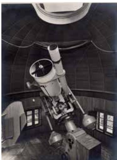
Il telescopio Zeiss da 60 cm
