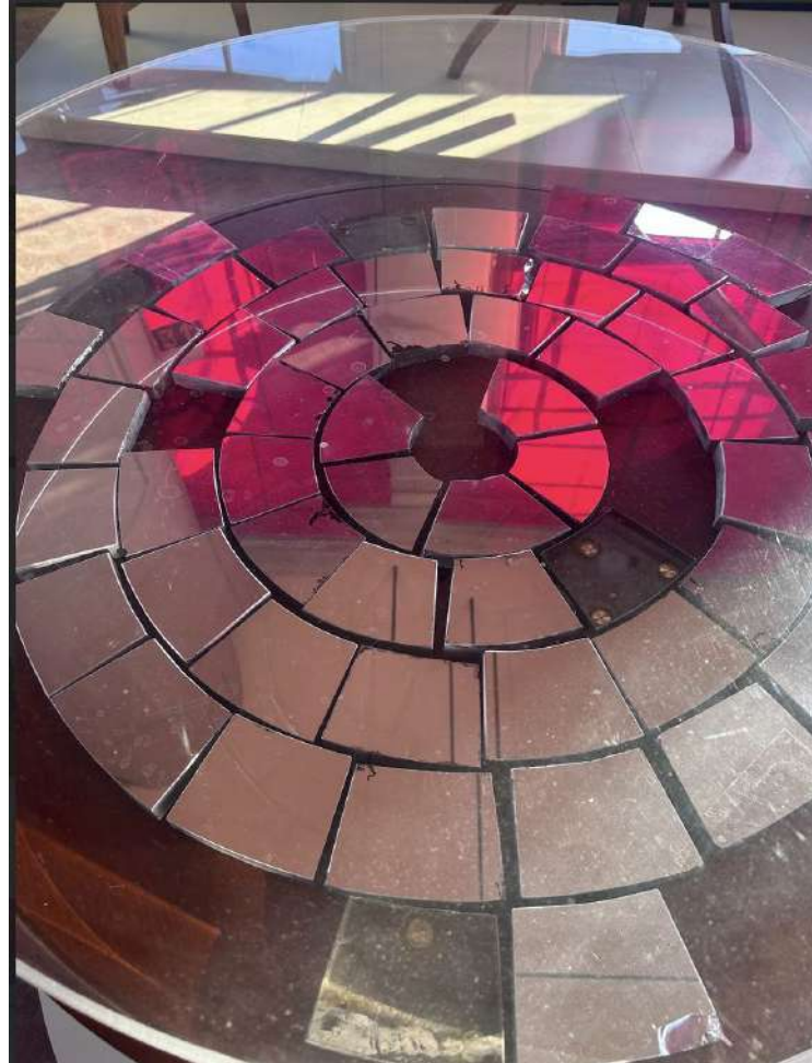
FIG. 6. In basso, i primi dieci tasselli del 1935 per il telescopio da 1 m, nella Sala della torretta della Specola. In alto: Horn d'Arturo sulla terrazza della Specola si affaccia all'apertura nel piano focale dello specchio a tasselli. Sulla crociera è montato il portalastr mobile e l'oculare per la guida durante l'esposizione; su una sbarra mobile, posta obliquamente all'apertura, si vede il collimatore che, opportunamente spostato, poteva controllare l'allineamento di ciascun tassello. (HORN D'ARTURO 1935)
